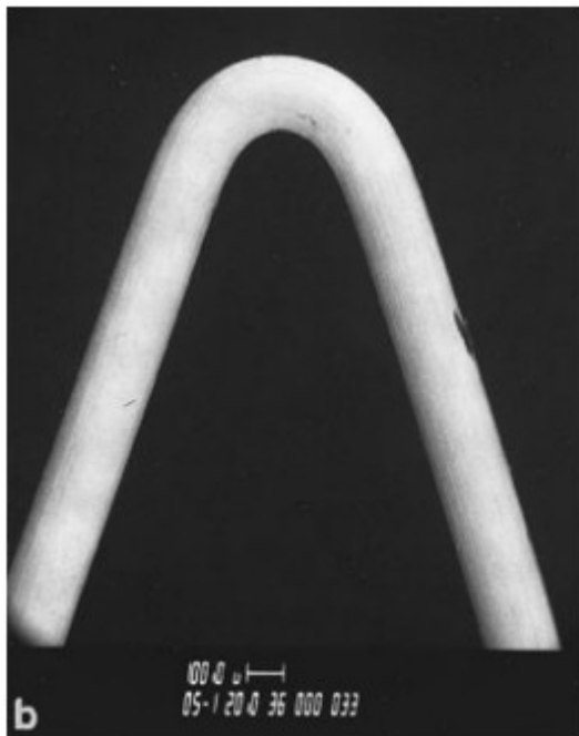
Tungsten wire thermionic emitter
